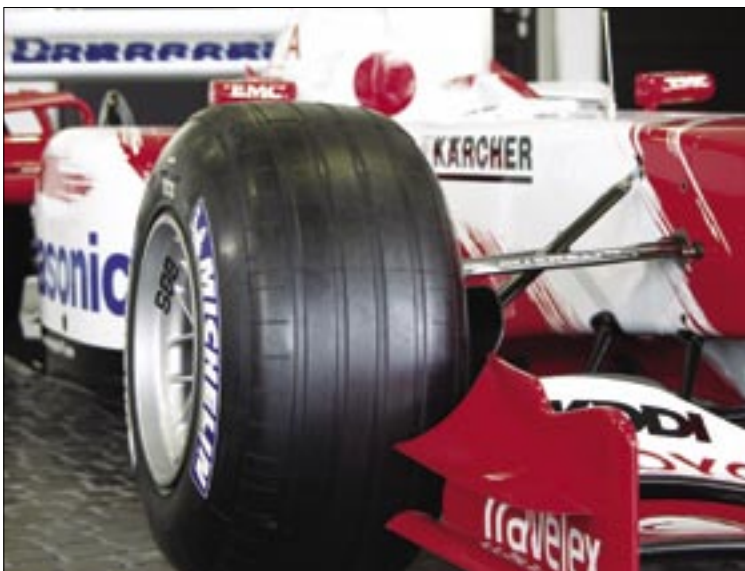
Wishbones – stabilizatorji koles iz karbonskih vlaken morajo vzdržati prav vse obremenitve.
